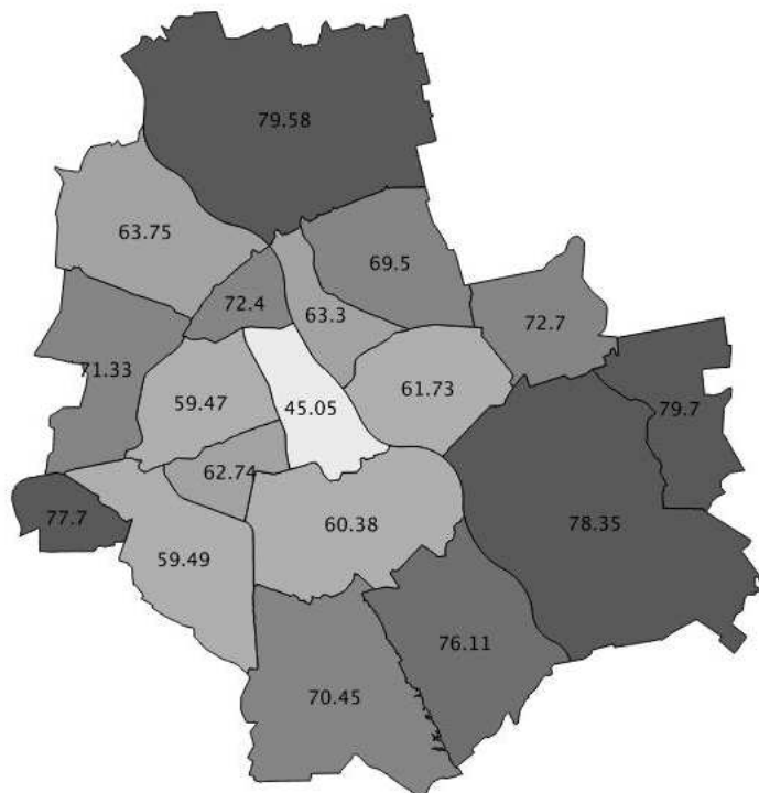
Rys. 3. Udział procentowy powierzchni dachowej w poszczególnych dzielnicach Warszawy bez możliwości wystąpienia zacienienia
