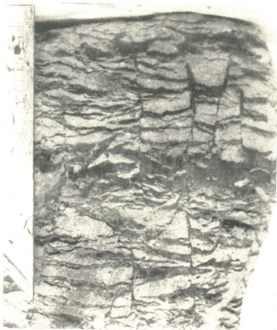
Phot. 1. Structure à réseau fin dans le limon gelé. Bandes foncées — glace
