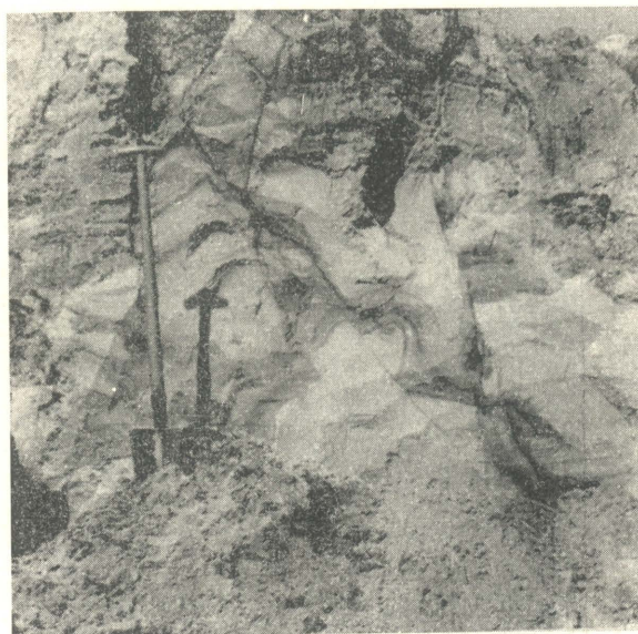
Photo 5. Involutions dans le niveau sablo-argileux 4a coupées par des failles karstiques diversement inclinées et de faible rejet (2 à 20 cm)
