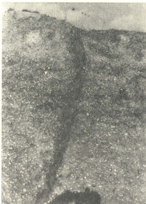
Photo 7. Fente à remplissage argileux brun (celle de droite de la figure 2) traversant le gravier 4a, dont certaines strates sont incurvées vers le haut au contact de la fente
