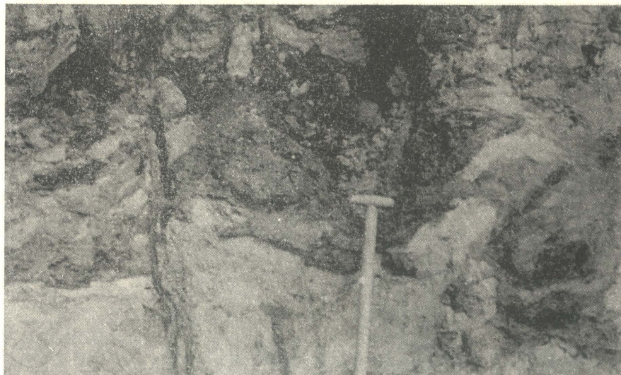
Photo 6. Fissure à remplissage argileux brun traversant le niveau sablo-graveleux 4a et recoupant ses involutions (la flechè pointe vers la fissure)
